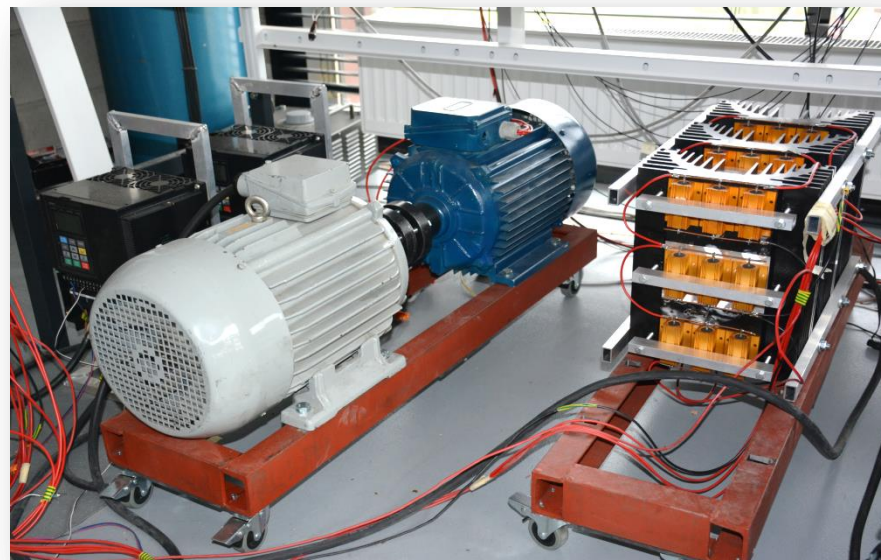
Elementy emulatora sieci elektroenergetycznej służącego do badań przekształtników DC/AC
